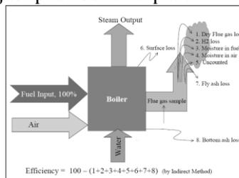
Gambar 1. Kehilangan panas pada boiler
